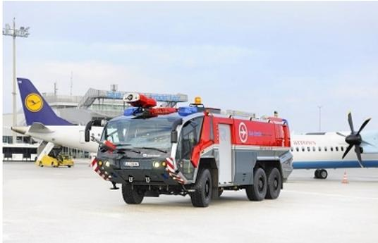
Der Flughafen Linz stellte dieser Tage mit dem Panther 6x6 aus dem Hause Rosenbauer ein neues Großlöschfahrzeug für den Flugbetrieb in Dienst. Somit verfügt nun auch der "Hausflughafen" des international erfolgreichen Feuerwehrfahrzeugherstellers aus Leonding über ein Fahrzeug aus der erfolgreichen Panther-Serie. Neben modernster Fahrzeugtechnik stehen auch insgesamt 14.620 Liter Löschmittel zur Verfügung.
