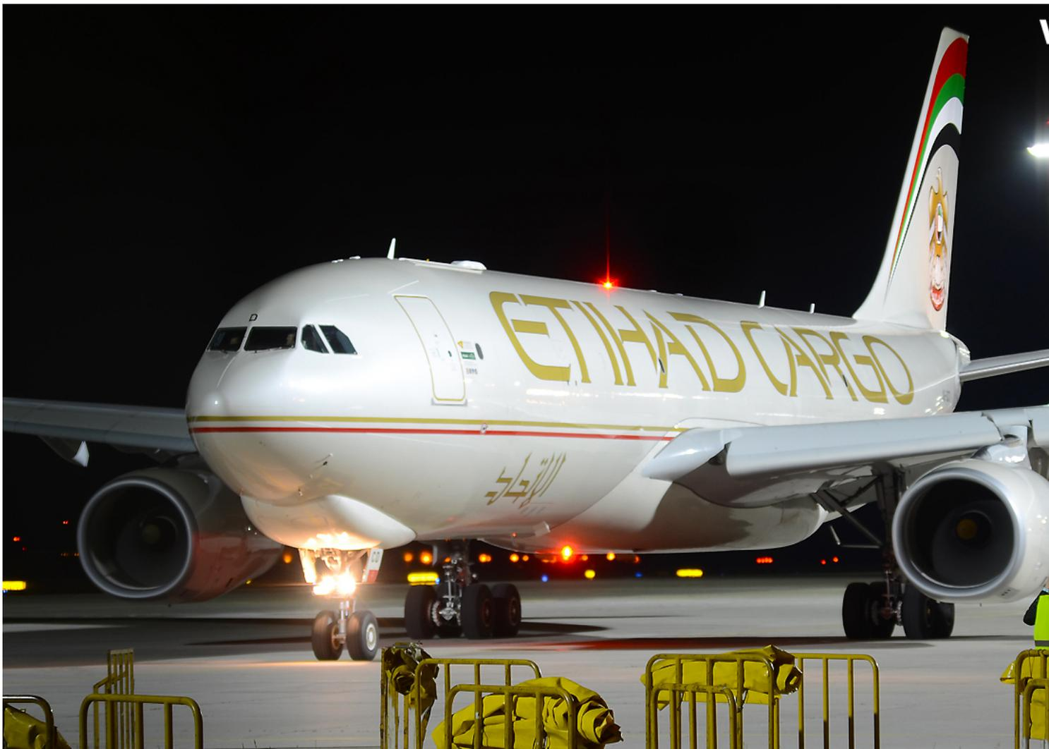
*Unverkennbar: der Buckel des Airbus A330-243F A6-DCD beim Hauptfahrwerk um die sonst übliche leichte Schräge der Kabine für Frachtoperationen auszugleichen (Foto: M. David)*
