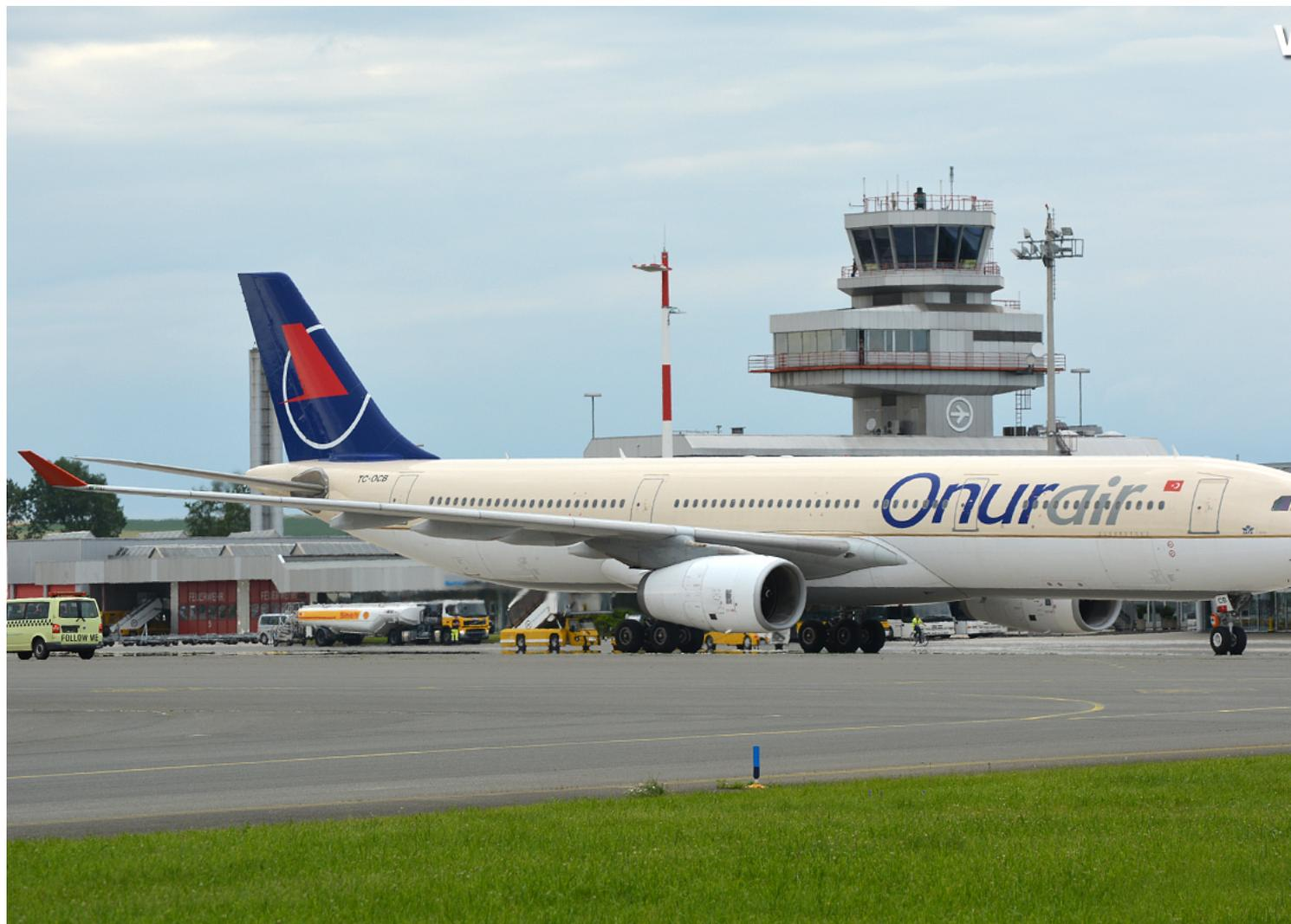
*Im Unterschied zur Vorwoche ist der Airbus A330-342 TC-OCG, Baujahr 1995 für Dragonair, mit Rolls-Royce Trent 772 Triebwerken ausgestattet und bietet Platz für 360 Passagiere*
