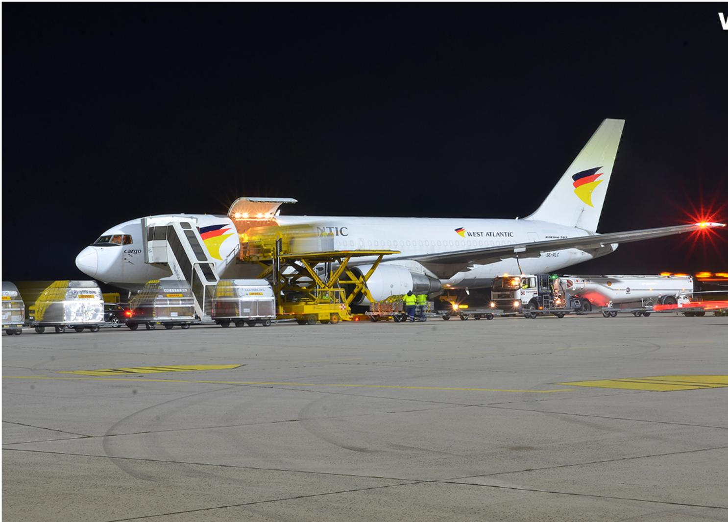
Bis zu 38 Container kann die Boeing 767-200BDSF von West Atlantic laden. Da es sich hierbei um ein zum Frachter umgebautes Passagierflugzeug handelt, kann dieses allerdings nicht die volle Nutzlast von etwa 58t Payload einer originalen Boeing 767-200F laden, deren Struktur schon beim Bau auf dieses Gewicht ausgelegt wurde (Foto: M. David)
